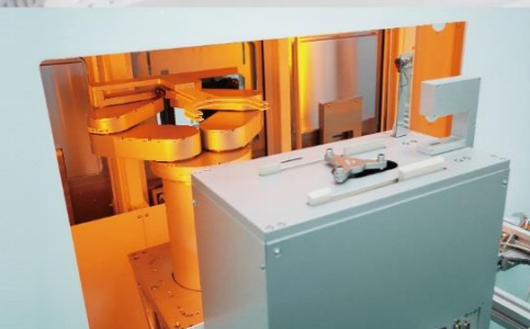
设备前端传输模块 EFEM 系统采用完全自主研发的 ATM 机械手、预对准器和装载装置，可根据客户实际需求定制解决方案 EFEM integrates SIASUN self-developed ATM robot, aligner and load-port to provide customized solutions.
